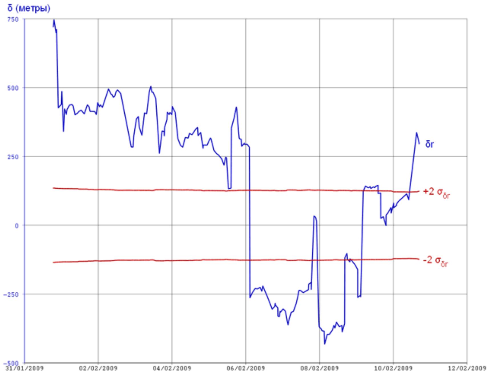
Рис.9 Реальные и расчетные ( 2\sigma ) ошибки определения относительного положения КА-Космос-2251 и Иридиум-33 в момент их столкновения по \delta_r (численный прогноз, поле 8x8, без адаптации и робастности)
